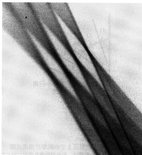
図10 螺旋軌道装置 (SCANORA) にて得られたスリット像
